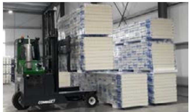
La distancia entre las uñas y el borde del pack debe ser la suficiente para no abollar o marcar los paneles.
